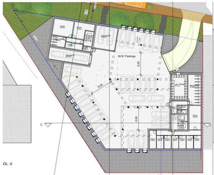
**Figure 19 : Parking souterrain projeté**
